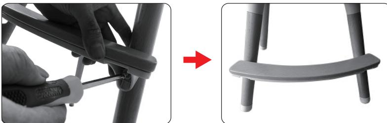
4. Installieren Sie die T-Stange unter der Grundwanne und achten Sie auf die Richtung des Nutteils
